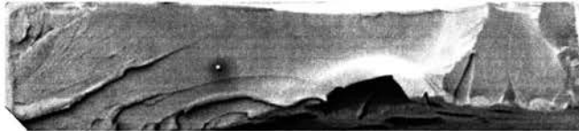
(D) \sigma_a = 36.5\text{Mpa} , \log(N_f) = 3.85
