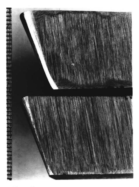
10X PHOTOMACROGRAPH, SIDE VIEW COMPARISON ROUGH TURNING TOOLS B & C REX AAA H.S. STEEL
