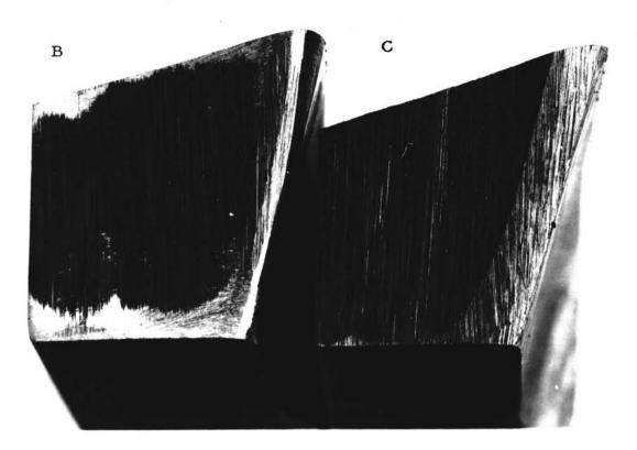
10X PHOTOMACROGRAPH, END VIEW COMPARISON ROUGH TURNING TOOLS B & C
