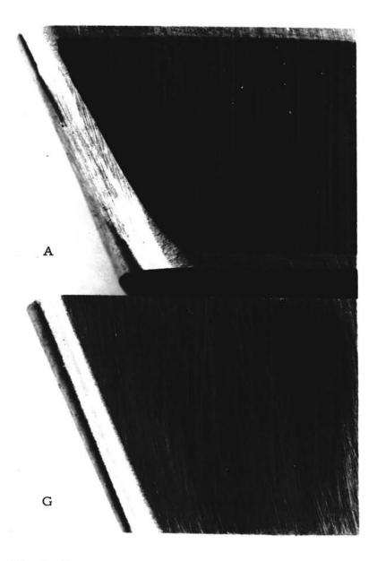
10X PHOTOMACROGRAPH, SIDE VIEW COMPARISON FLAT GROUND TOOL A & HOLLOW GROUND TOOL G
