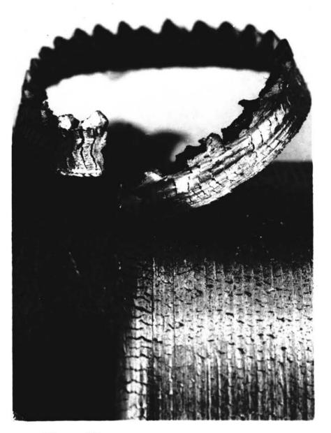
10X PHOTOMACROGRAPH, FORMATION OF ROUGH TURNING CHIP SAE 1020 STEEL TOOL STOPPED IN CUT
