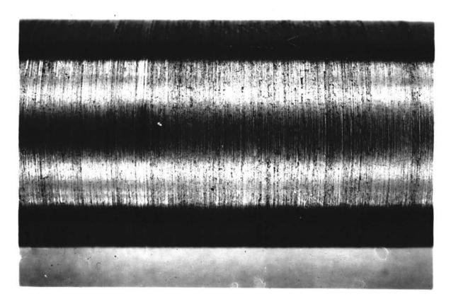
10X PHOTOMACROGRAPH OF POOR SURFACE FINISH SAE 1020 STEEL
