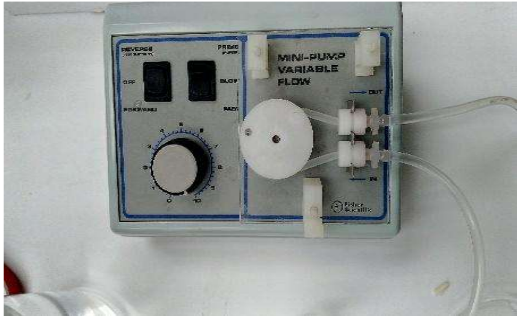
Figure 4-2: A mini variable Flow Pump
