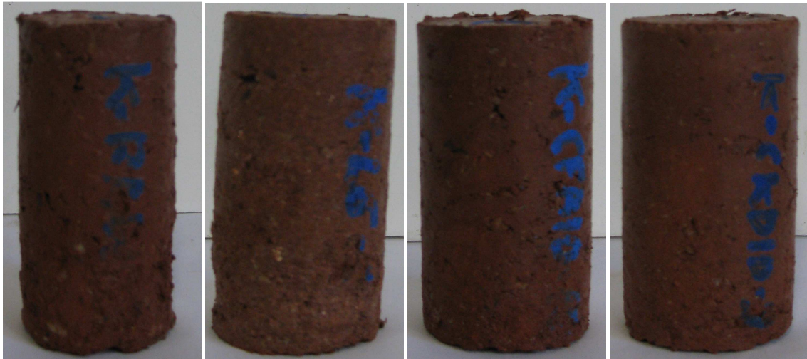
(a) Raw (b) 6% Lime (c) 10% CFA (d) 10% CKD
