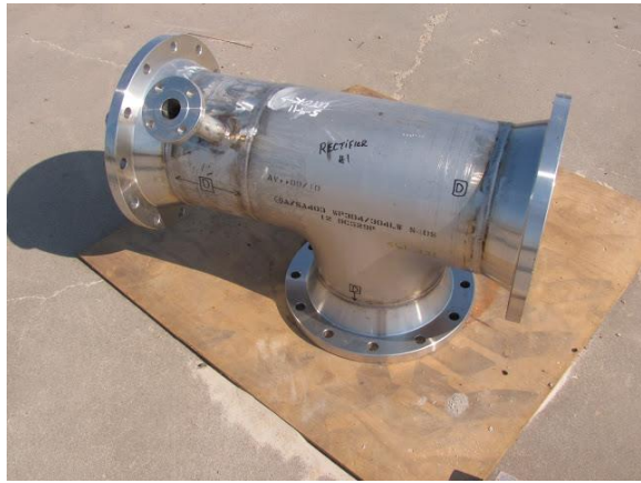
(d) Rectifier Top Flange
