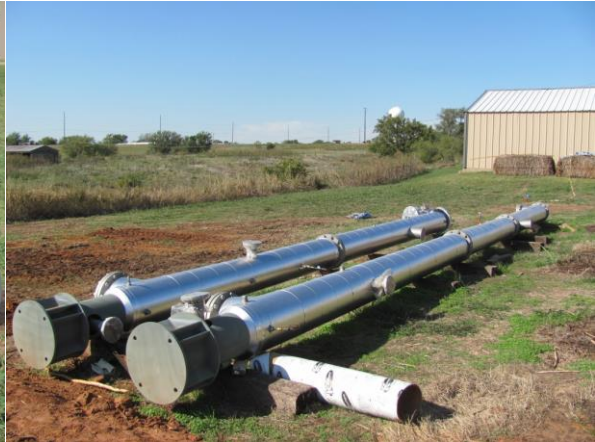
(d) Columns after insulation
