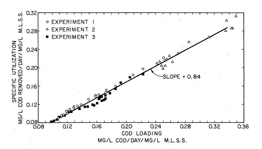
Figure 8. Effluent Loading Curve (Synthetic Waste)
