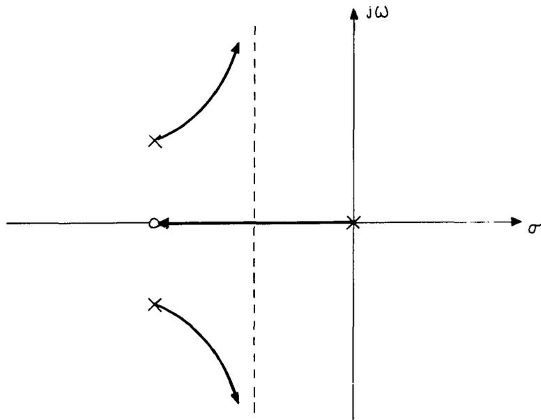
FIG. 19. POLE-ZERO PLOT OF SECOND-ORDER SYSTEM.
