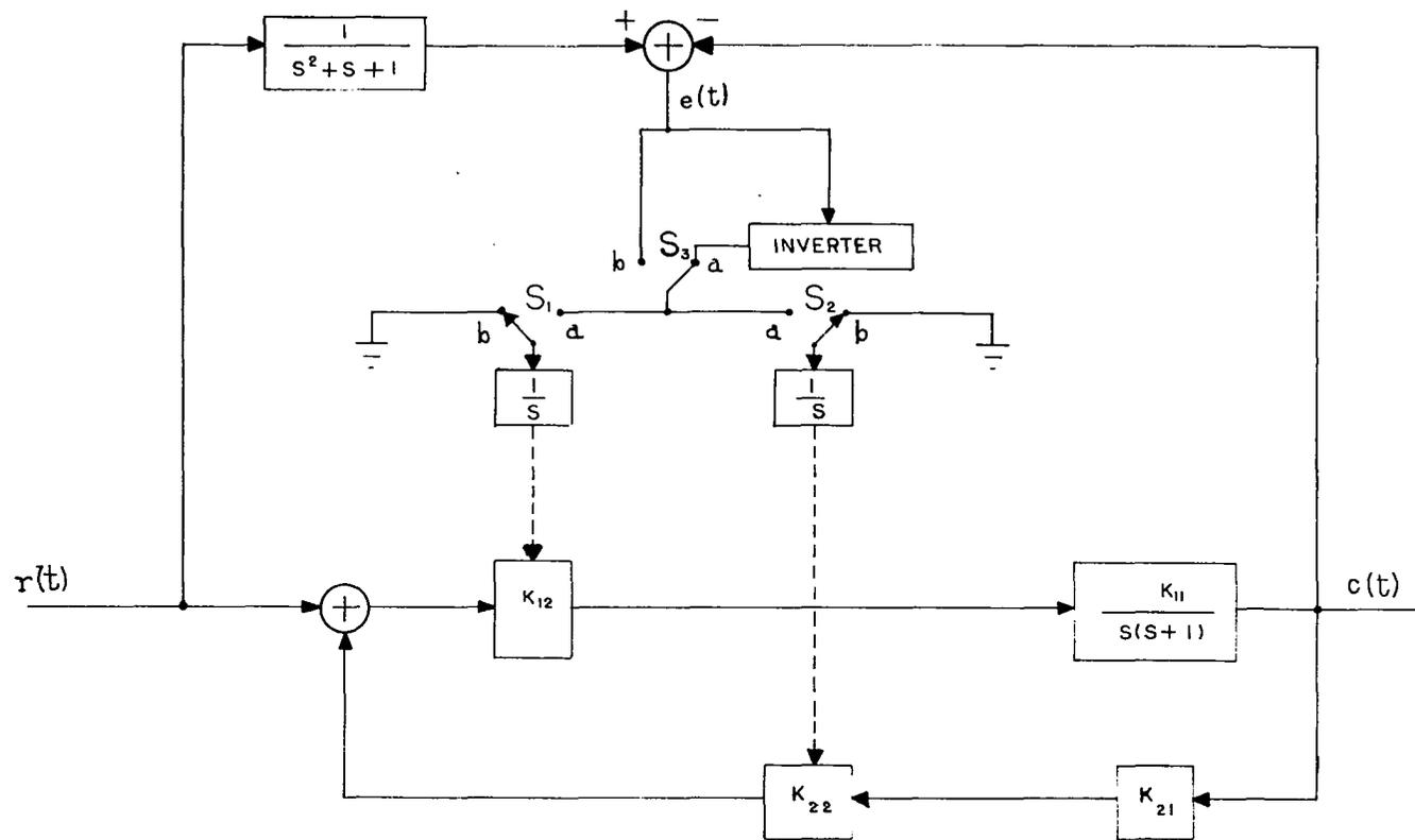
FIG. 10. MODEL-REFERENCE ADAPTIVE SYSTEM. FROM ADAPTIVE CONTROL SYSTEMS, BY MISHKIN & BRAUN. COPYRIGHT 1961. MCGRAW-HILL BOOK CO., INC. USED BY PERMISSION.
