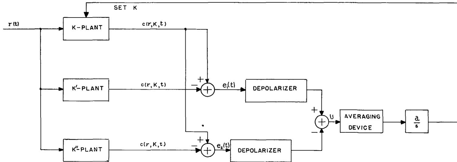
FIG. II. ERROR COMPARISON ADAPTIVE CONTROL SYSTEM.
