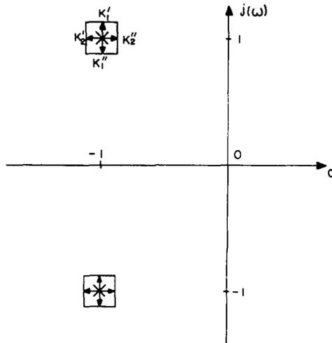
FIG. 32. REGION OF OPERATION FOR A SECOND-ORDER PLANT.
