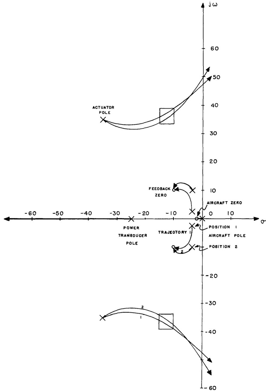
FIG. 23. POLE-ZERO PLOT OF AIRCRAFT CONTROL SYSTEM.
