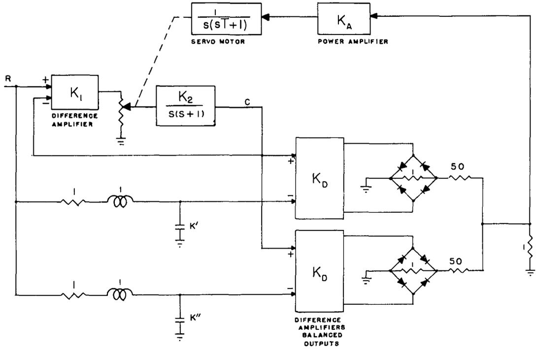
FIG. 18. SECOND-ORDER SYSTEM COMPONENTS.
