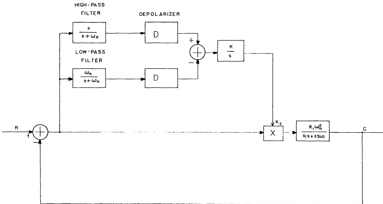
FIG. 1. MARX'S FREQUENCY SENSITIVE SERVO. FROM ADAPTIVE CONTROL SYSTEMS, BY MISHKIN & BRAUN, COPYRIGHT 1961. USED BY PERMISSION.
