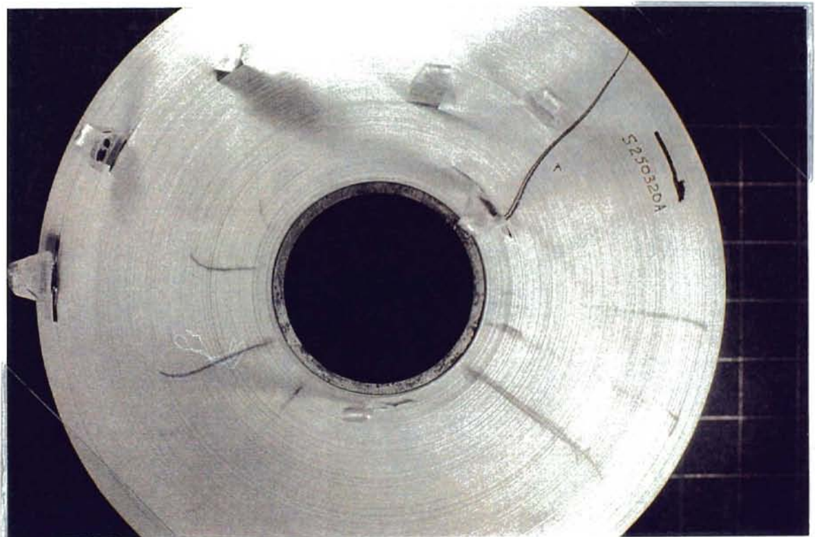
J-LINES 2.5 INCH NIP ROLLER, 0.5 PLI WEB LINE TENSION, 3.33 PLI NIP LOAD
