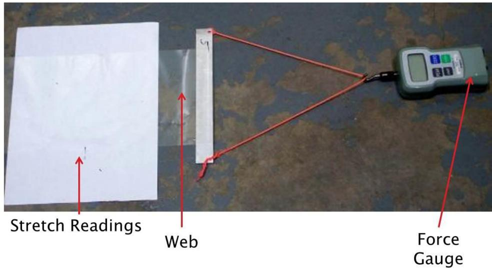
**Figure 4.5 : Stretch Test setup.[7]**
