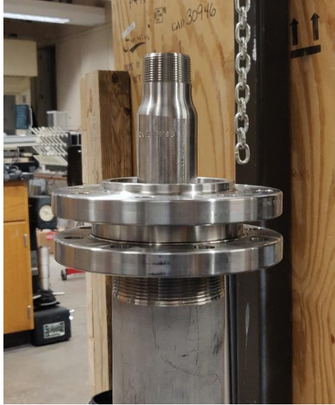
Fig. 44 Rod Pump Hold-Down Flanges
